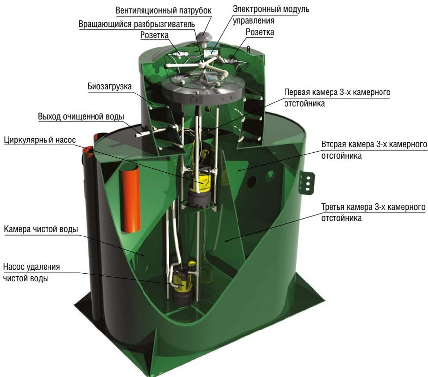
Рисунок 2. Схема станции **Alta Bio** со встроенным колодецем для сбора очищенной воды и напорным выбросом
