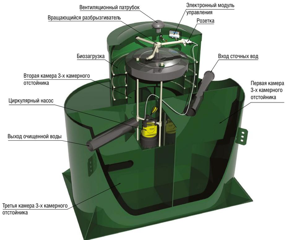
Рисунок 1. Схема работы Станции **Alta Bio**
