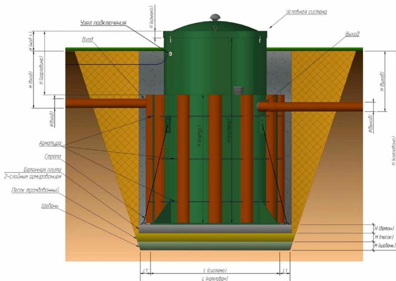
**Простой самотечный выпуск** в придорожную канаву, овраг, ливневую систему, а также непосредственно на грунт при условии соответствующего рельефа местности.
